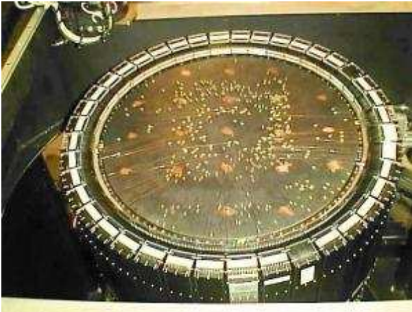
Figure 2: Mode Medusa : support des têtes de fibres positionnables, chacune à l'extrémité d'un bras mobile, au foyer Nasmyth.
