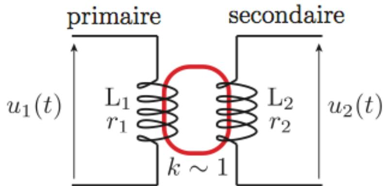
Puisque  $k=1$ , le flux  $\phi_0$  traversant la surface d'une spire du circuit 1 et du circuit 2 est le même.
