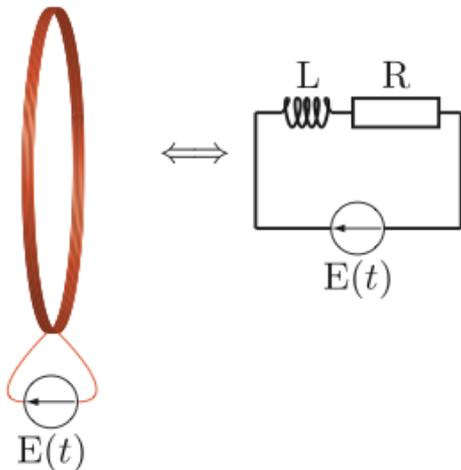
Circuit équivalent d'une bobine alimentée par un générateur de tension alternatif.
