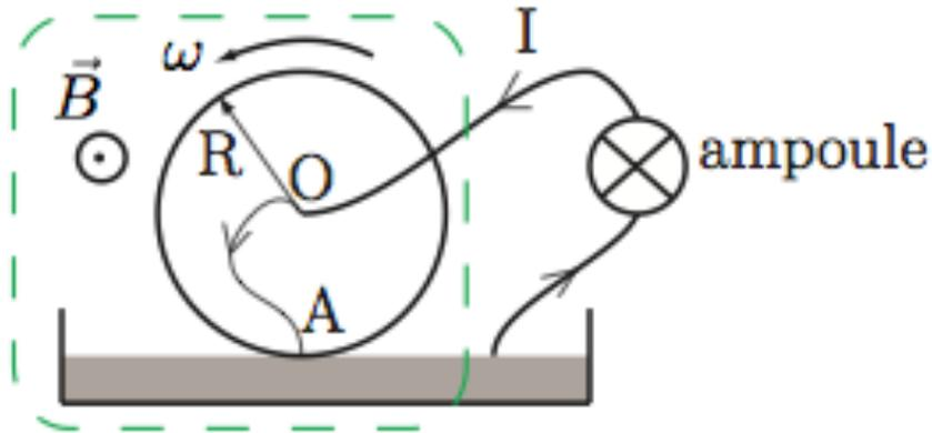
On fait tourner le disque à la main avec une pulsation  $\omega$  : l'ampoule s'allume !
