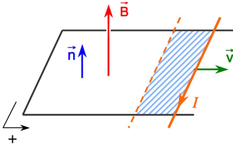
On met en mouvement une barre métallique dans un champ  $B$  uniforme
