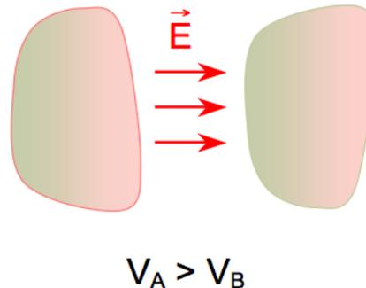
Il apparaît un champ électrique, qui va modifier la répartition de la charge en surface, et va polariser les deux conducteurs.
