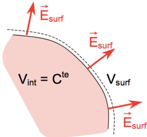
Ce résultat est cohérent avec le fait que la surface d'un conducteur est équipotentielle (le champ étant toujours perpendiculaire aux équipotentiels)
