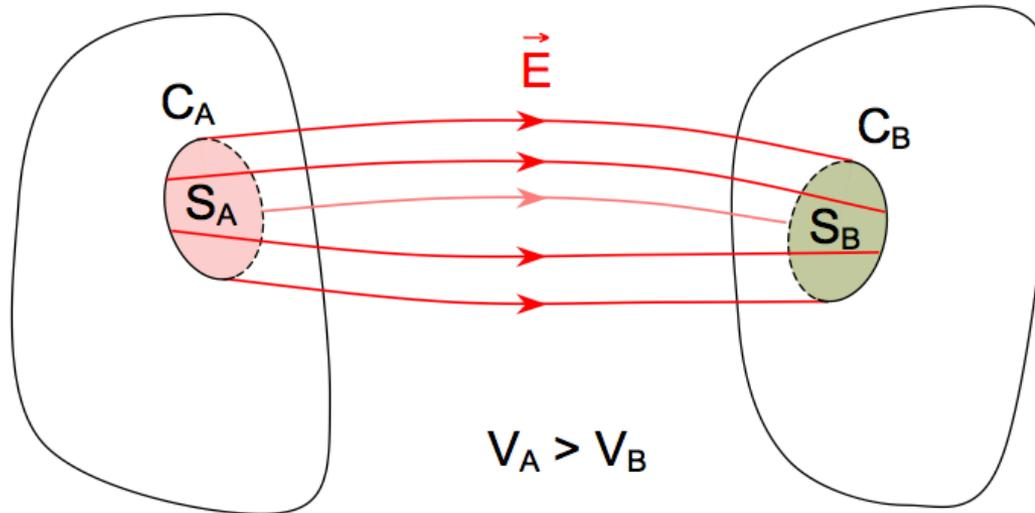
L'application du théorème de Gauss sur ce tube refermé par deux éléments de surface intérieurs aux conducteurs (ou le champ est nul) donne le résultat
