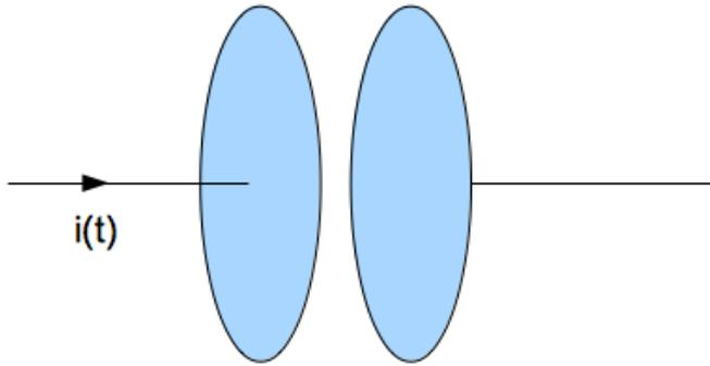
Les deux plaques sont séparées par un isolant : le courant qui traverse le condensateur n'est pas un courant de conduction, mais de déplacement (c'est pourquoi il est nul en régime continu)
